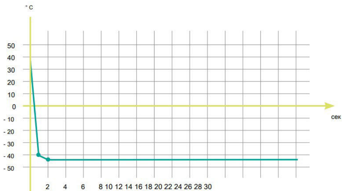
Рисунок 5 – Схематическое изображение кривой охлаждения криозондом
