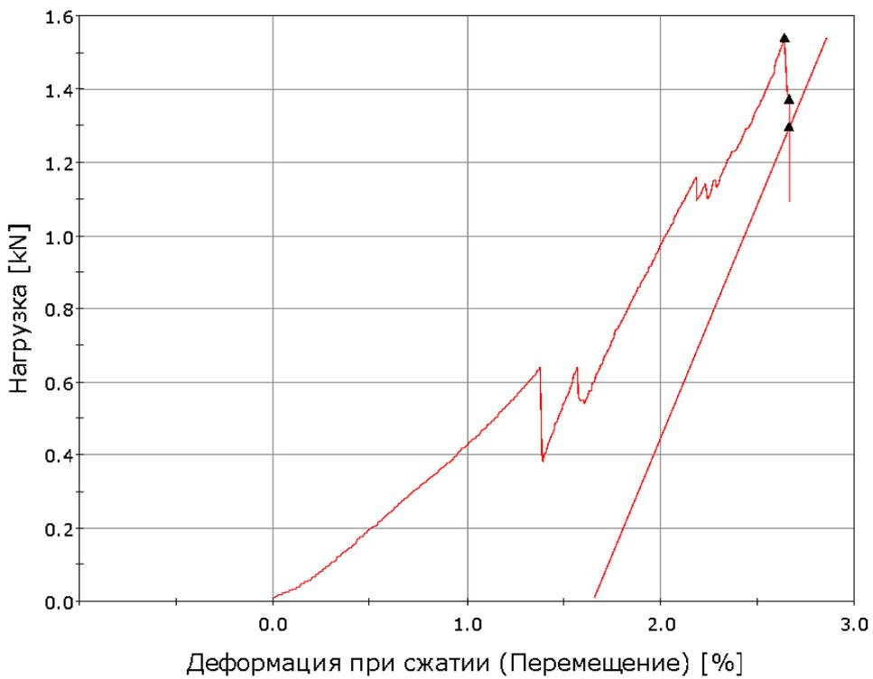
Рисунок 3.4 – Сила, приложенная к образцам группы 2 без термоциклирования, вызвавшая их разрушение
