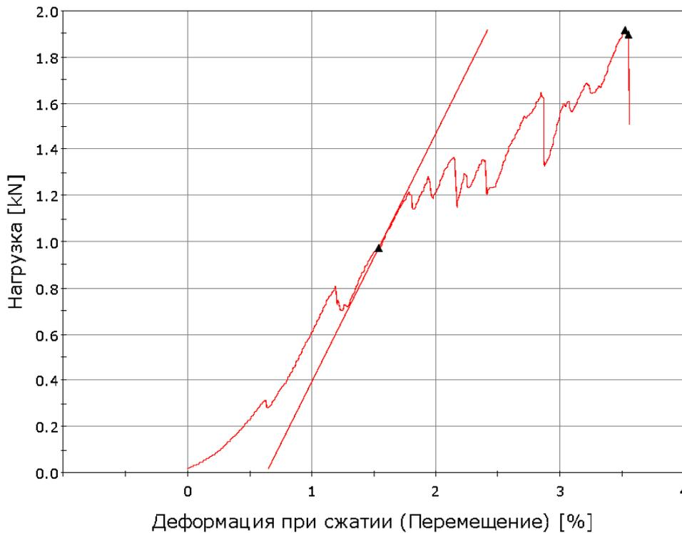
Рисунок 3.2 – Сила, приложенная к образцам группы 1 без термоциклирования, вызвавшая их разрушение
