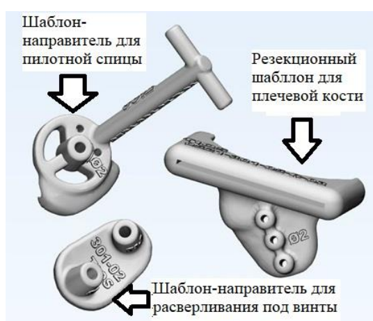
Рисунок 6 – Индивидуальный инструментарий. Шаблоны направители: виртуальные 3D-модели
