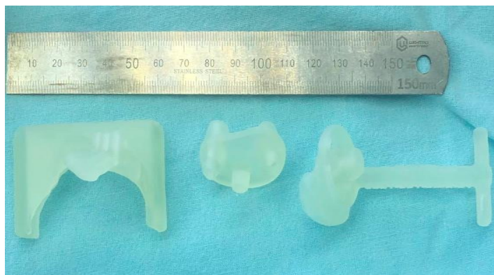
Рисунок 9 – Напечатанные 3D-направители и резекционный шаблон
