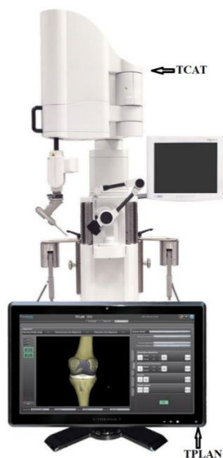
Рисунок 3.1 - Роботизированная хирургическая (ортопедическая) система «TSolution One®» (THINK Surgical, Inc., CA, USA)
