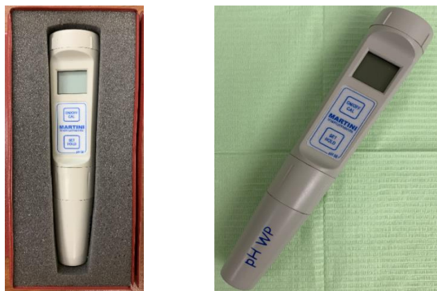
Рисунок 3 – Профессиональный прибор-анализатор кислотности и температуры воды Milwaukee pH56 во влагозащищенном корпусе
