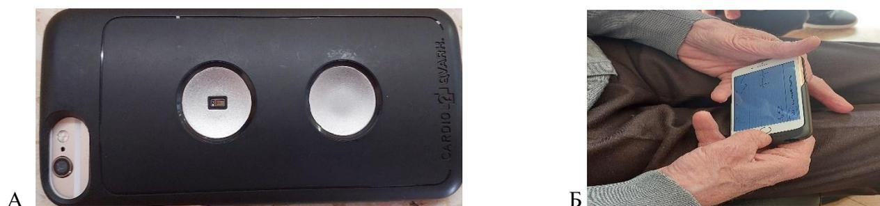
Рисунок 2 - А. Одноканальный портативный электрокардиограф «CardioQVARK» с датчиками для регистрации фотоплетизмографии и электрокардиограммы; Б. Процесс записи одноканальной электрокардиограммы
