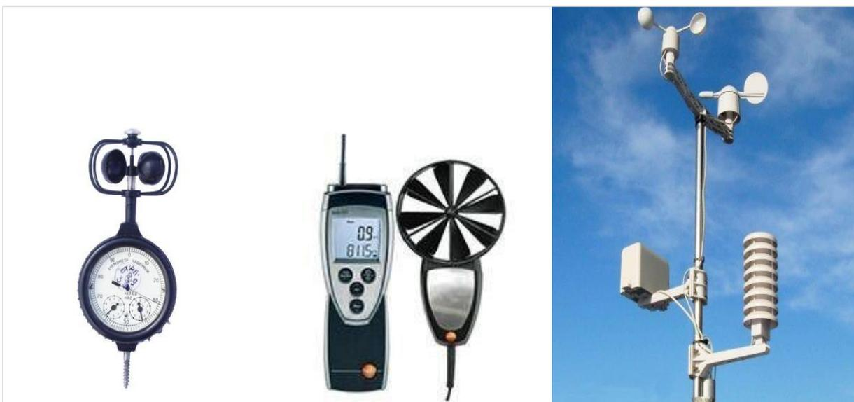
Рис. 2. Анемометры (слева - чашечный, в центре – крыльчатый, справа – метеостанция с чашечным анемометром)
