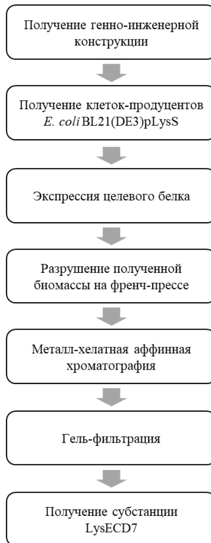
Рисунок 12 – Схема технологии получения субстанции эндолизина LysECD7
