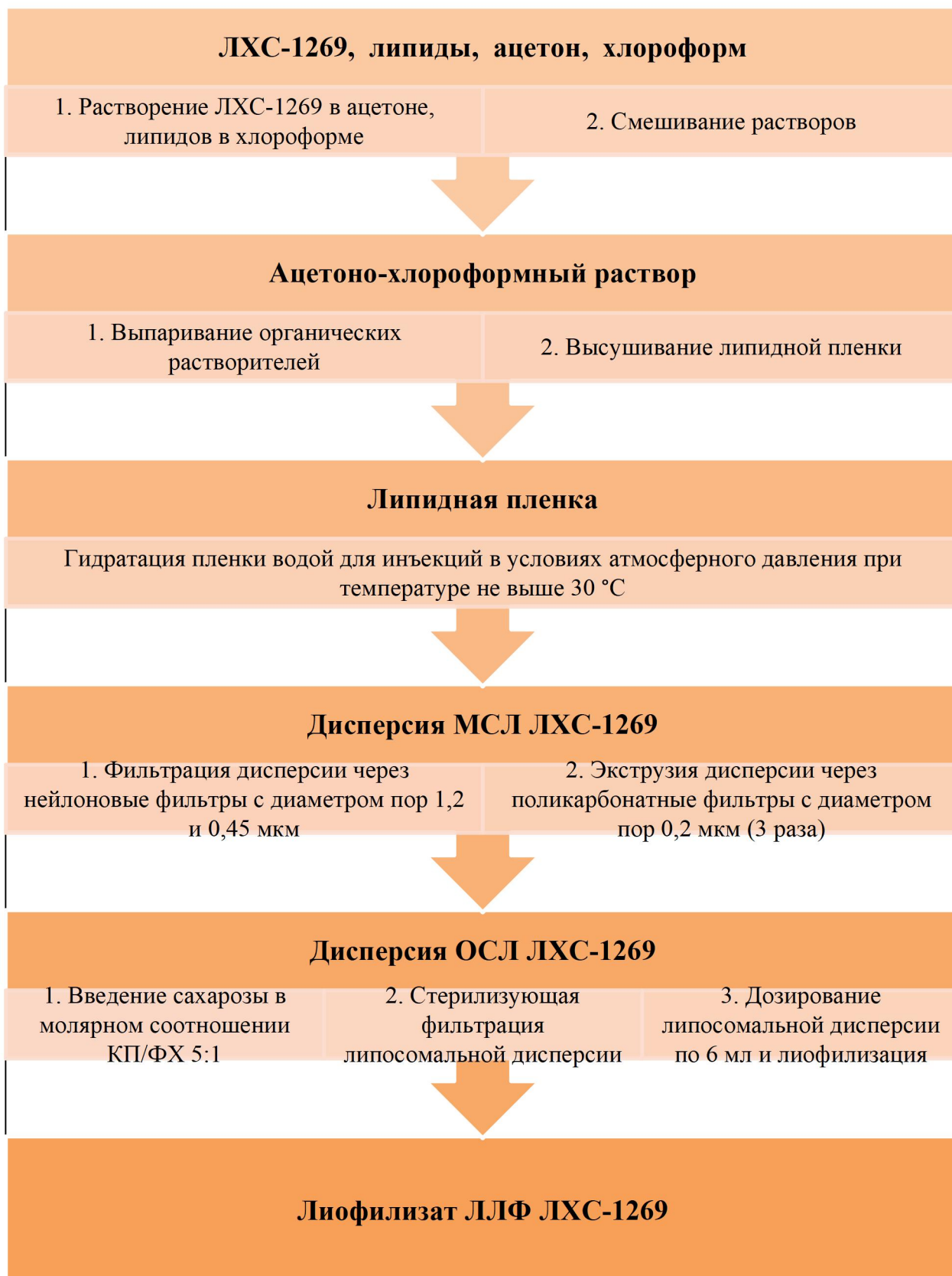
Рисунок 24–Схема технологии получения ЛЛЛФ ЛХС-1269
