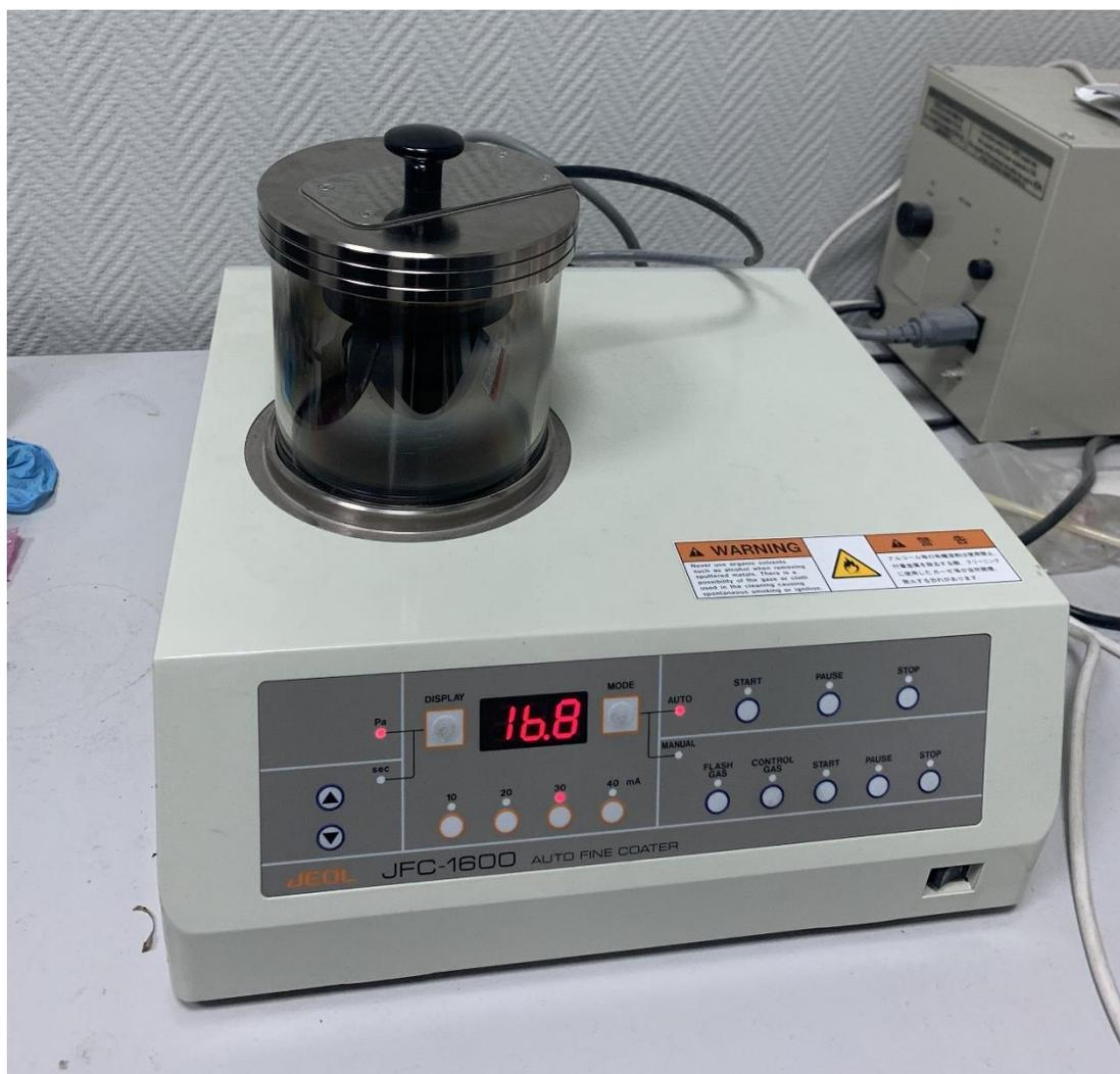
Рисунок 2.4. Установка магнетронного напыления «Jeol» «JFC-1600»
