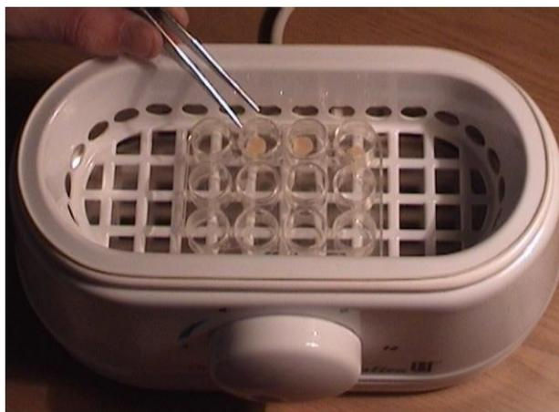
Рисунок 2.8. Обработка ультразвуком образца стоматологического материала Dentokeep Peek для изготовления провизорных коронок («Геософт», РФ).
