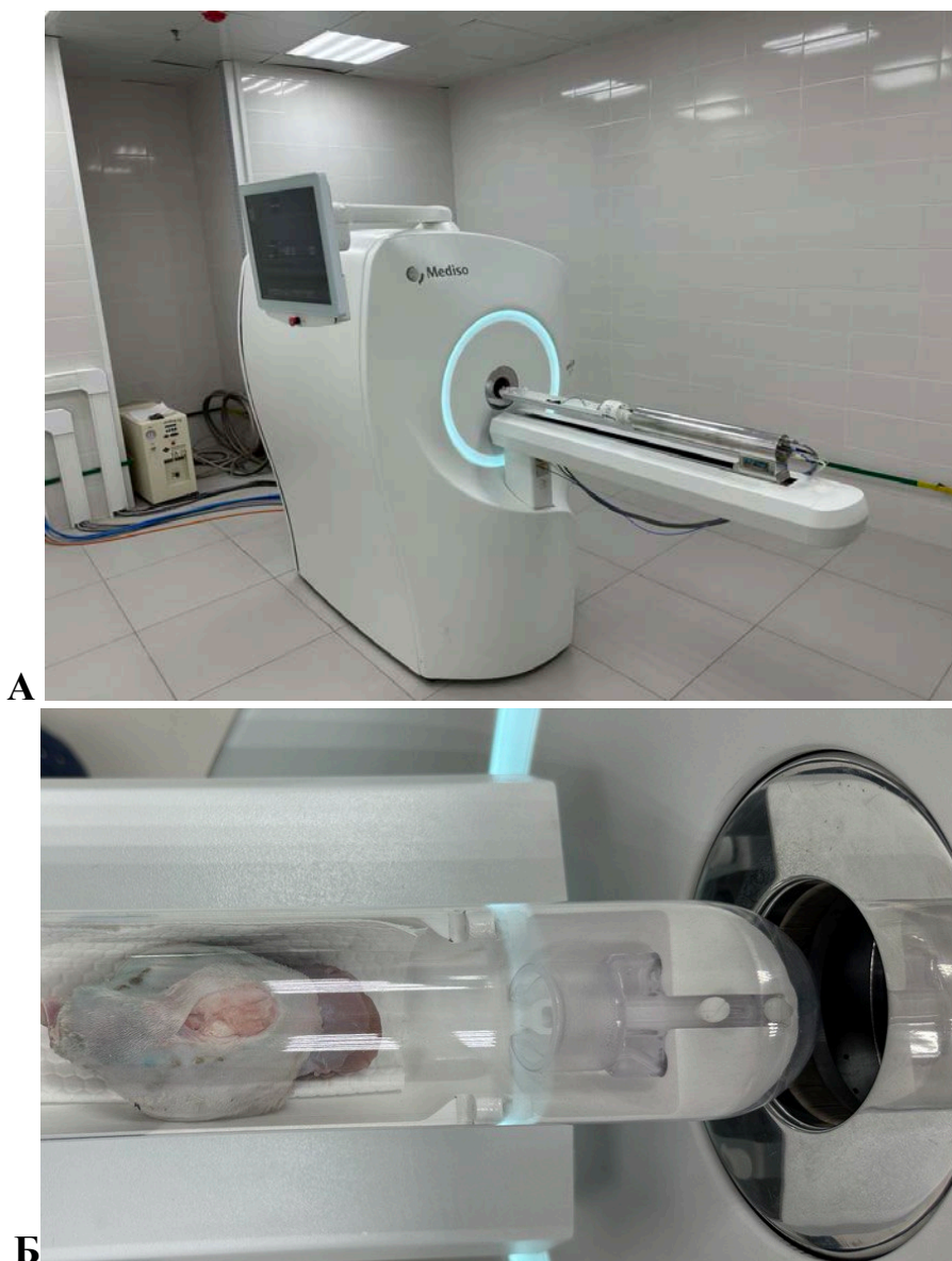
Рисунок 2.12 – 7Т магнитно-резонансный томограф nanoScan (Mediso, Венгрия) (А) и эксплантат коленного сустава кролика в капсуле МРТ перед исследованием (Б)
