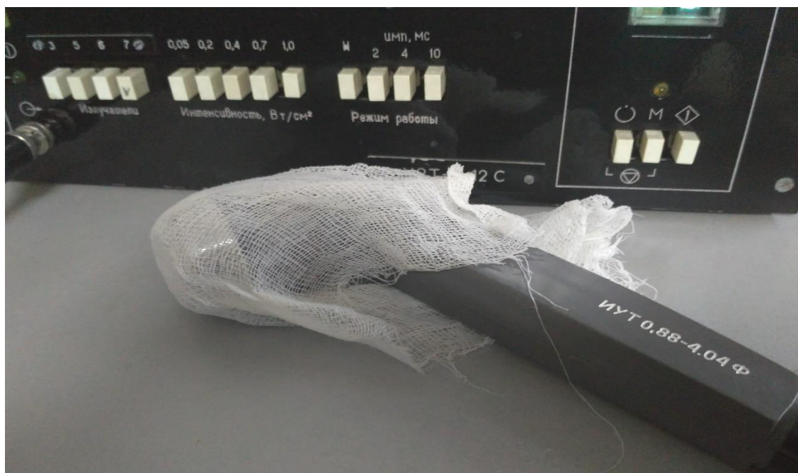
Рисунок 8 – Ультразвуковой излучатель, обернутый двухслойной марлевой салфеткой
