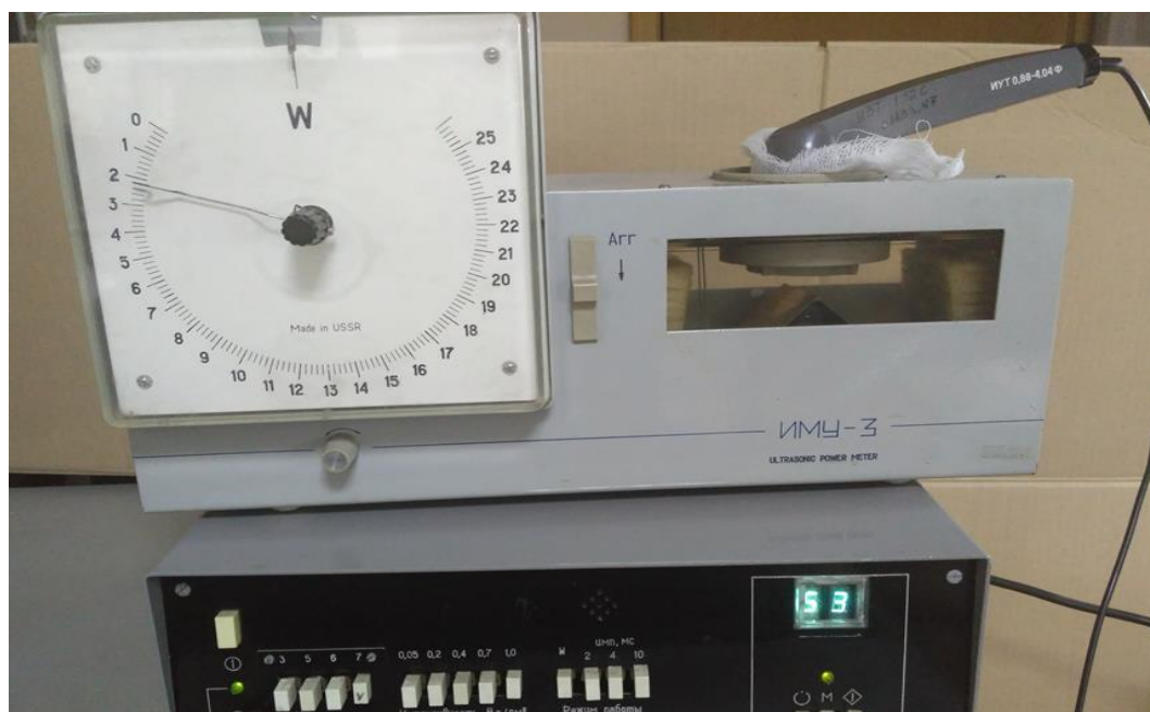
Рисунок 9 –Измерение мощности высокочастотного ультразвукового излучения с двухслойной марлевой салфеткой
