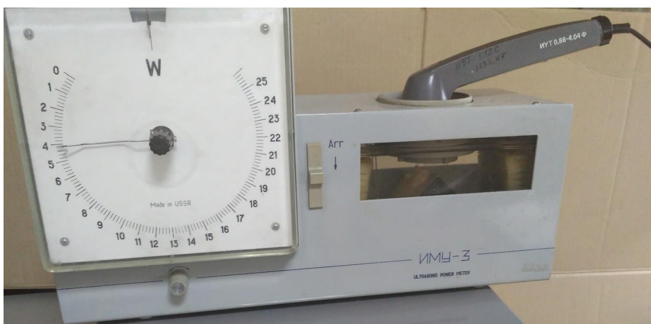
Рисунок 7 – Измерение мощности высокочастотного ультразвукового излучения без марлевой салфетки
