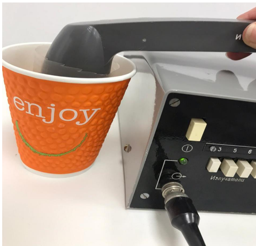
Рисунок 4 – Озвучивание раствора мирамистина ультразвуком высокой частоты
