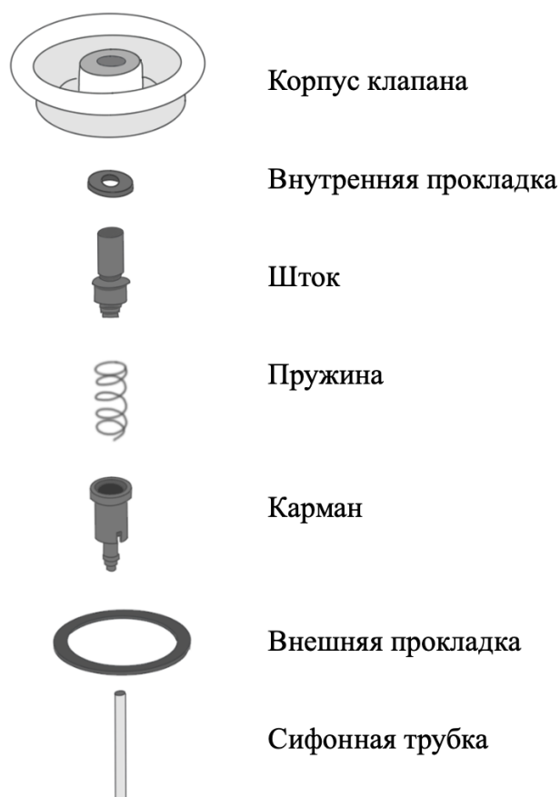
Рисунок 1.5 – Строение аэрозольного клапана
