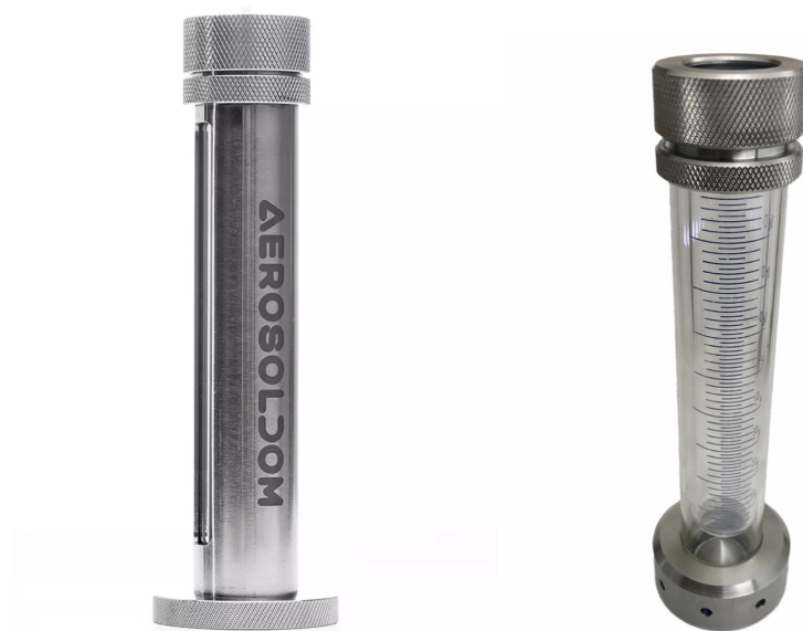
Рисунок 1.6 – Лабораторные (испытательные) аэрозольные колбы для оптического контроля
