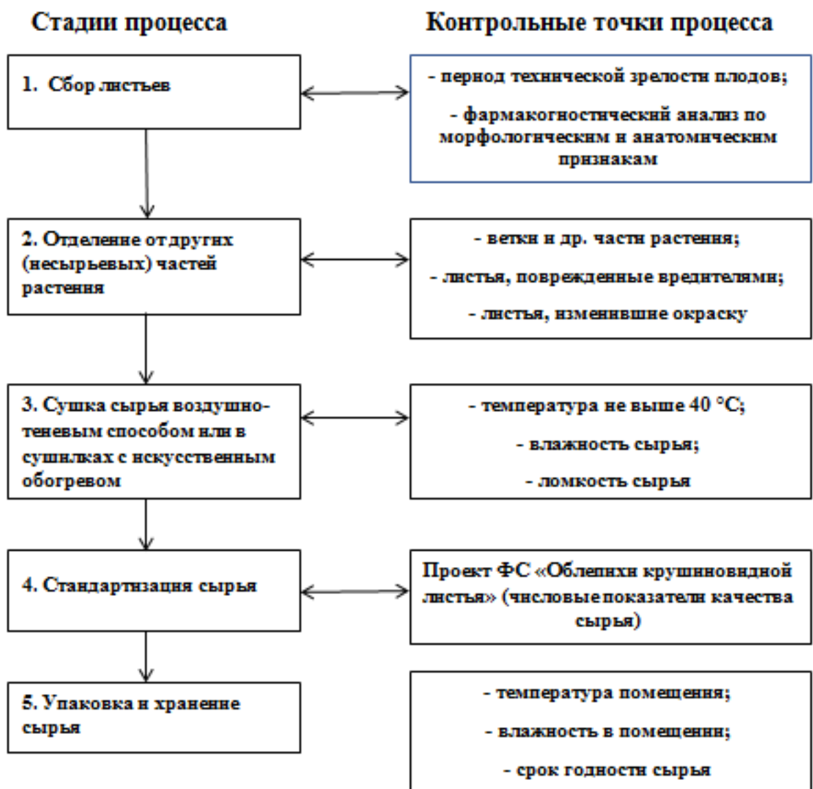
Рисунок 75 – Технологическая схема заготовки листьев облепихи крушиновидной
