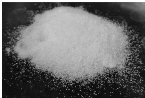
Рисунок 16 – Простые МК состава 1,0% альгинат натрия / 0,5% \text{CaCl}_2 после лиофильного высушивания
