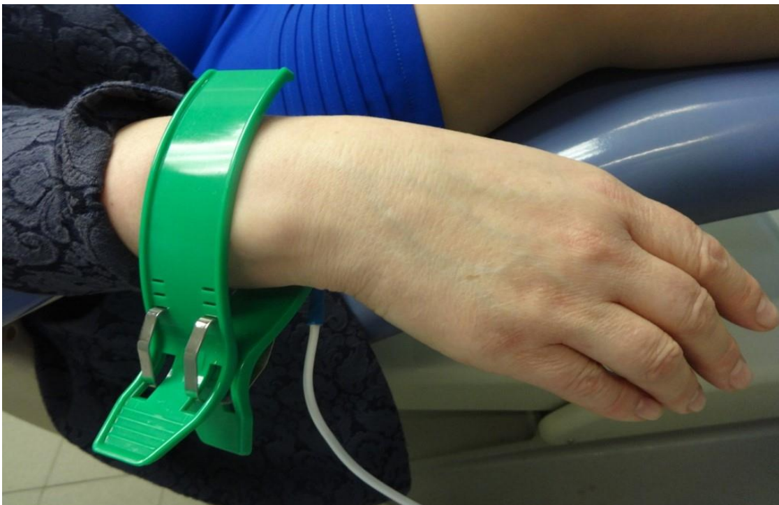
Рисунок 8. Расположение пассивного электрода сравнения при определении электрохимических потенциалов
