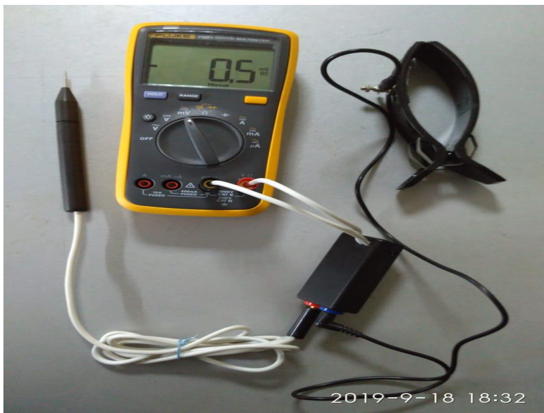
Рисунок 5. Мультиметр Fluke 115 с набором электродов
