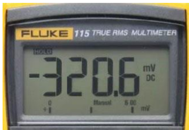
Рисунок 10. Показания милливольтметра при определении электрохимических потенциалов
