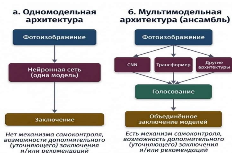
Рисунок 7 – Сопоставление одномоделной и мультимодельной архитектуры: а – одномоделная программа, б – мультимодельная программа
