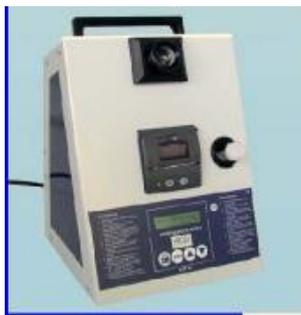
Приборы для определения температуры плавления
