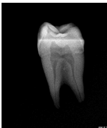
Рисунок 5 – Рентгенограмма образца зуба для измерения толщины остаточного дентина методом спектроскопии диффузного отражения (модель 2)
