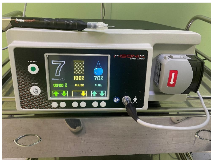
Рисунок 3.20– Ультразвуковой скальпель, использованный при проведении атравматичной костно-хрящевой резекции
