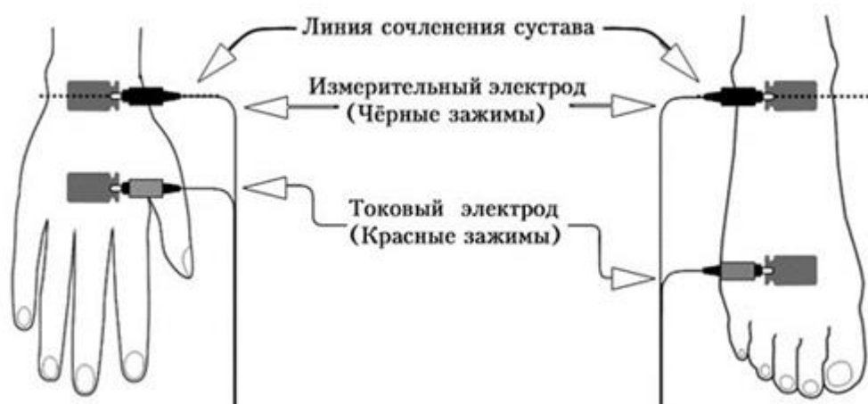
Рисунок 4 – Расположение электродов при выполнении биоимпедансного обследования [47]
