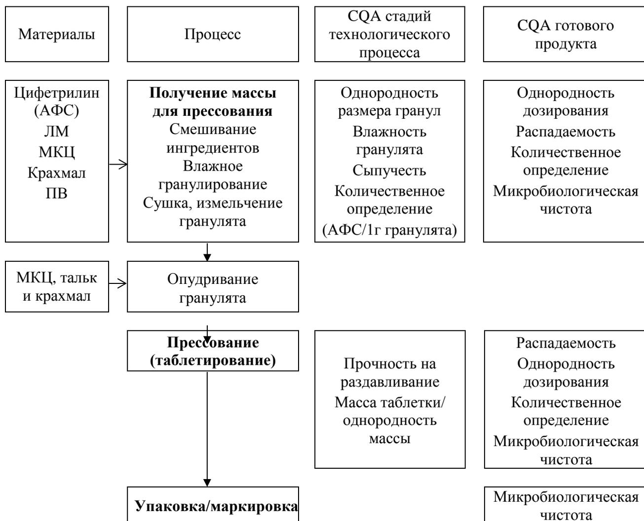
Рисунок 11 – Связь между операциями технологического процесса получения таблеток цифетрилина и критическими показателями качества
