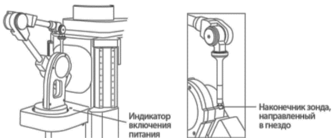
Рисунок 56 - Зонд регистратора положения, вид регистратора (А); начальное расположение регистратора положения для калибровки – схема (Б)
