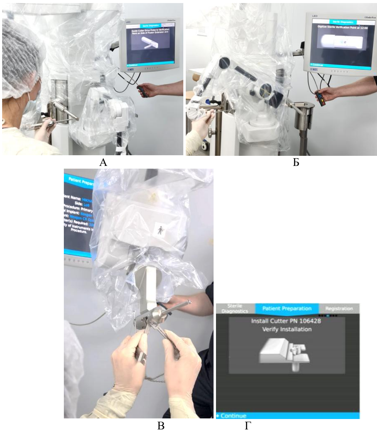
Рисунок 59 - Калибровка узла фрезера, манипулятора (А); калибровка диджитайзера (Б); фиксация режущего инструмента (В), экран (Г)
