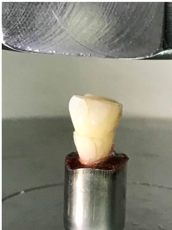
**Рисунок 4.19.** Образец без термоциклирования «кариес дентина — прямая реставрация», разрушенный при испытаниях.
