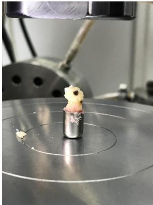
**Рисунок 4.12. Образец без термоциклирования «абфракционный дефект — прямая реставрация», разрушенный при испытаниях.**
