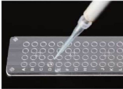
Нанесение образцов на мишень (Используются мишени FlexNass-SR или FlexMass-DS)
