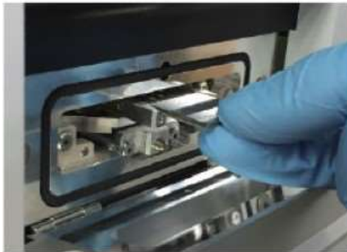
Установка мишени в прибор и откачка вакуума
