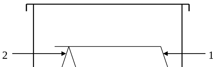
Рисунок 7. Установка пластинки в камере: 1 – фитиль, 2 – подставка.
